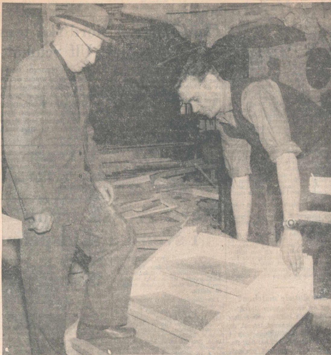
Fabrikör Nils Andersson och sonen Rune slutkontrollerar en kökstrappa som är klar för leverans. Det är viktigt att proportionerna mellan plansteg och sättsteg är riktiga säger fabrikören.
